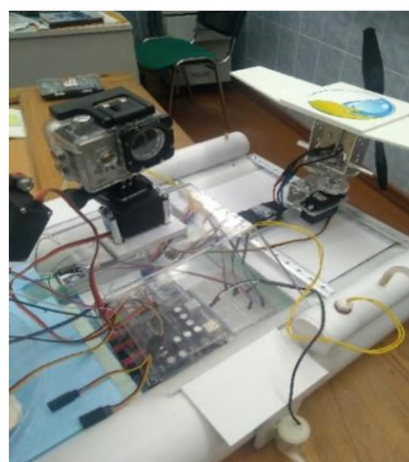
Рис. 1. Размещение оборудования для забора проб воды на корпусе глиссера
