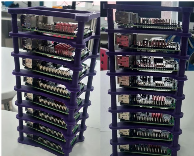
Рис. 1-2. Готовая конструкция кластера на основе одноплатного компьютера Raspberry Pi Model 3 B+
