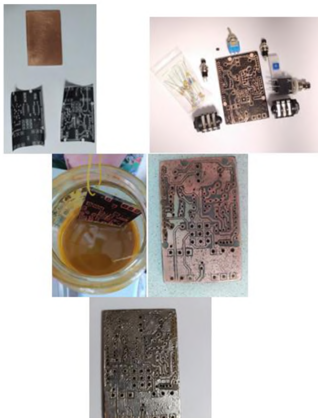
Рис. 1. Перенос трафарета на электролит, а также травление, очистка и лужение платы
