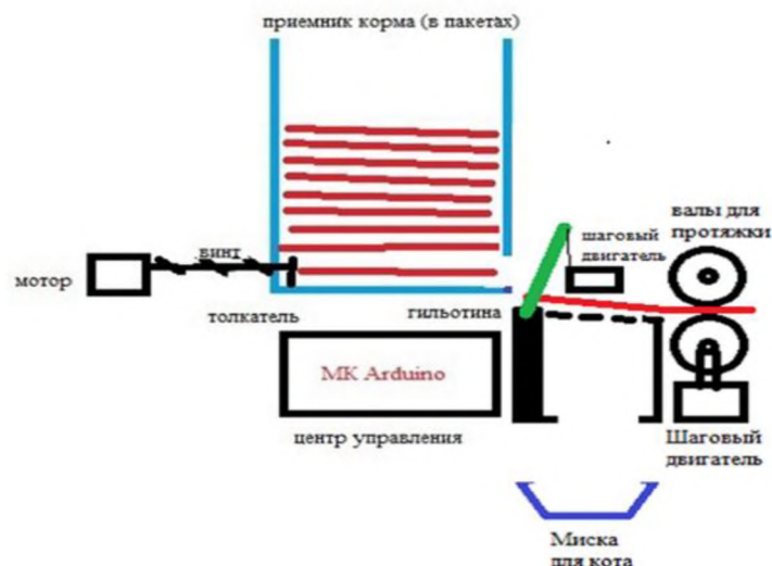
Рис. 1. Схема устройства кошачьей кормушки для влажного корма «Пух»
