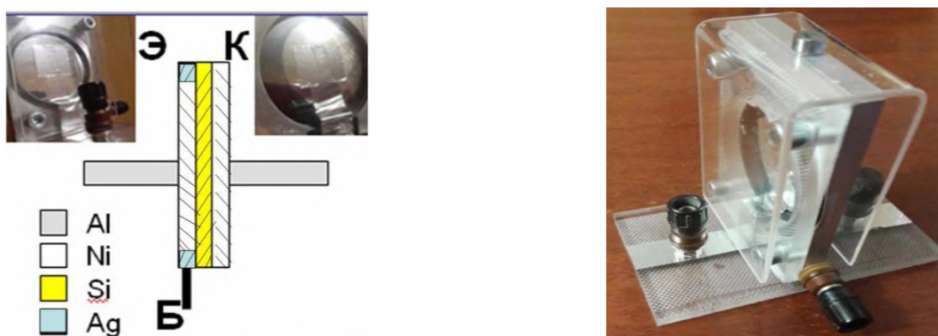
Рис. 3 а) сэндвич-структура транзистора; б) транзистор
