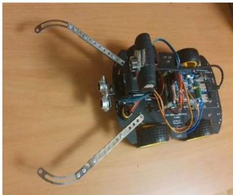
Рис. 2. Приспособления для захвата и удержания мячей
