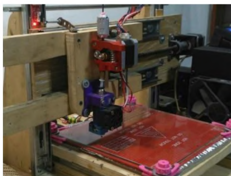
Рис. 4. Размещение блока экструдера и механизма подачи
