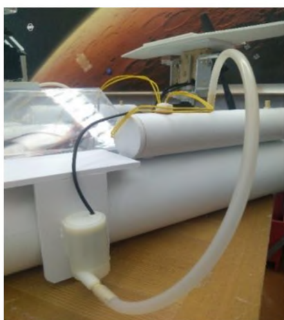
Рис. 1. Размещение оборудования для забора проб воды на корпусе глиссера
